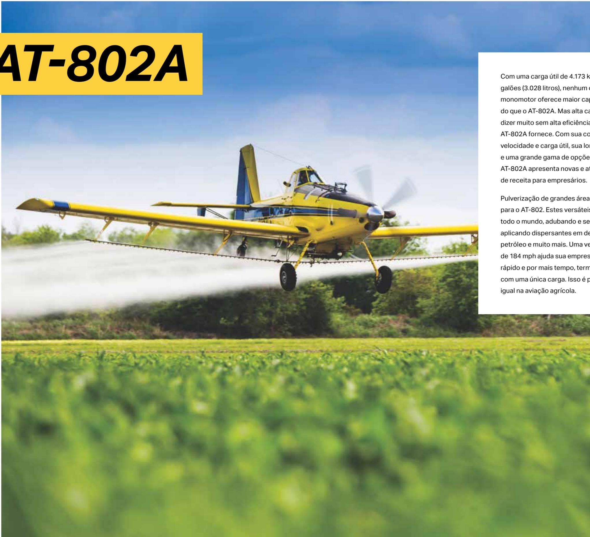
Com uma carga útil de 4.173 kg e um hopper de 800 galões (3.028 litros), nenhum outro avião agrícola monomotor oferece maior capacidade de trabalho do que o AT-802A. Mas alta capacidade não quer dizer muito sem alta eficiência – e é isso o que o AT-802A fornece. Com sua combinação de potência, velocidade e carga útil, sua longa lista de acessórios e uma grande gama de opções da Air Tractor, o AT-802A apresenta novas e atrativas oportunidades de receita para empresários.
